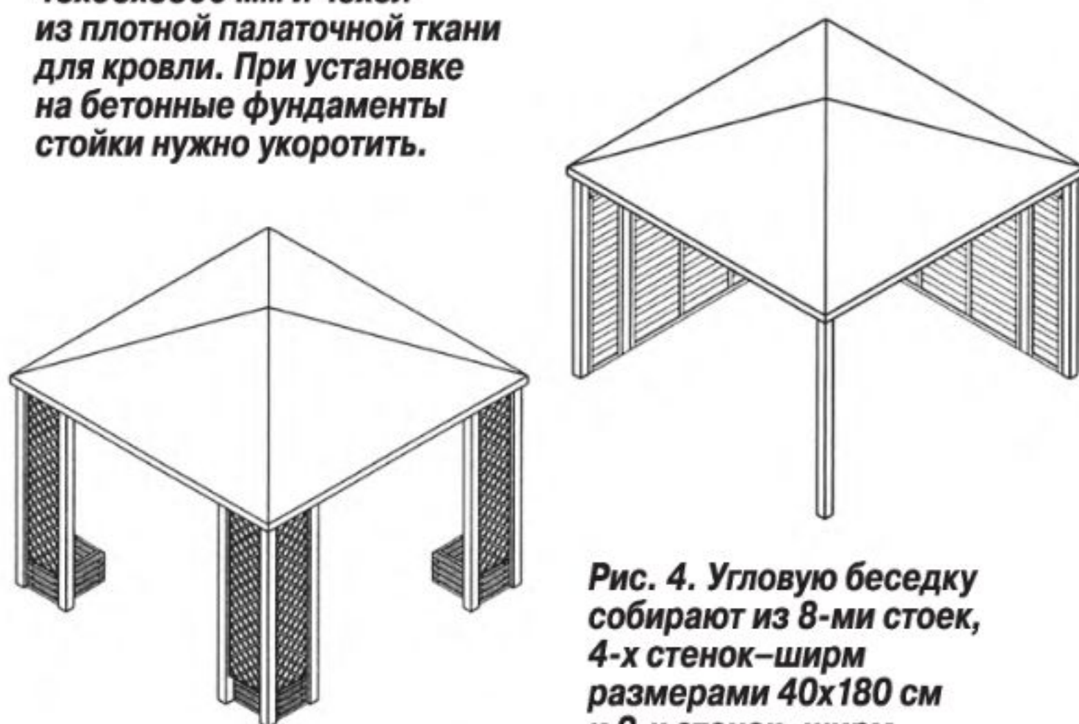
Рис. 2. Частично обустроенный вариант беседки сделать несколько сложнее. Для него уже понадобятся 12 стоек, а дополнительно — 4 ящика для цветов и 8 декоративных решёток.
