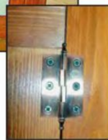
Приступаем к окончательной сборке шкафа. Для навешивания дверок мы выбрали декоративные бронзовые петли.
