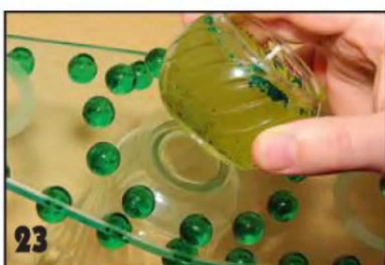
22 Наносим каплю клея на подготовленную контактную площадку шарика и приклеиваем его к полочке в предусмотренном месте. Разложив шарики на полке, выносим её на солнце (этот клей затвердевает только под действием УФ-лучей). Так приклеиваем все шарики.
