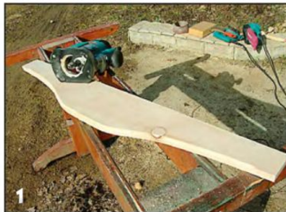
Единственная фигурная деталь шкафа — декоративная фасадная доска верхней перемычки. Выпилив её по контуру, кромки фрезеруем фасонной фрезой и тщательно шлифуем.
