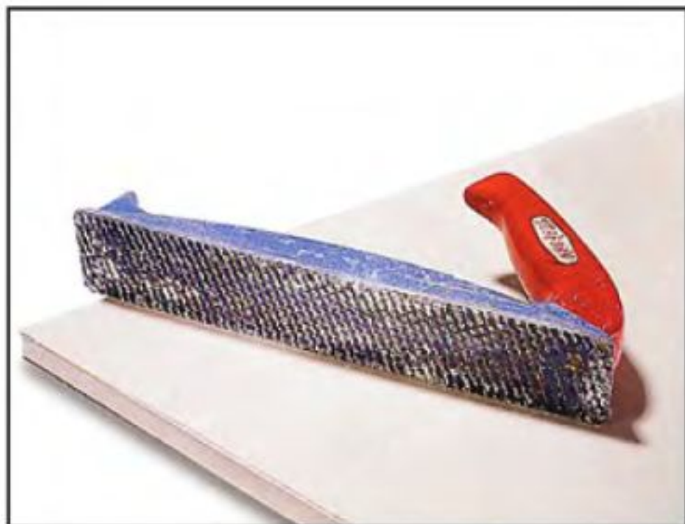
Кромки гипсокартонных листов лучше всего зачистить специальным рашпилем для гипсокартона (называют его и рубанком), мелкие острые лезвия которого легко сглаживают неровности.
